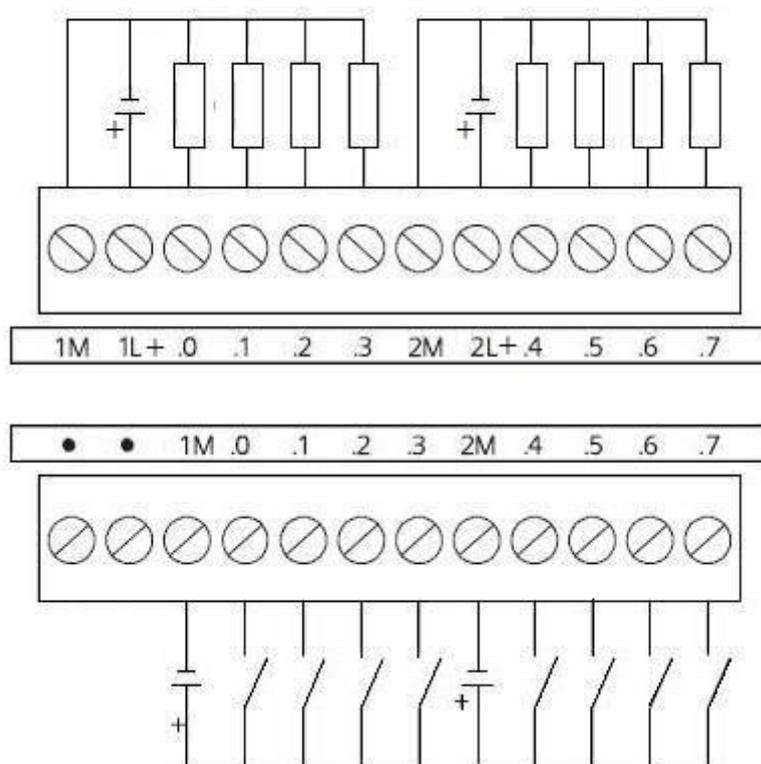
S7-200 数字量模块可安装在 CPU 模块右侧的任意位置。每个 S7-200 数字量模块都自带一根带状 I/O 总线电缆，
