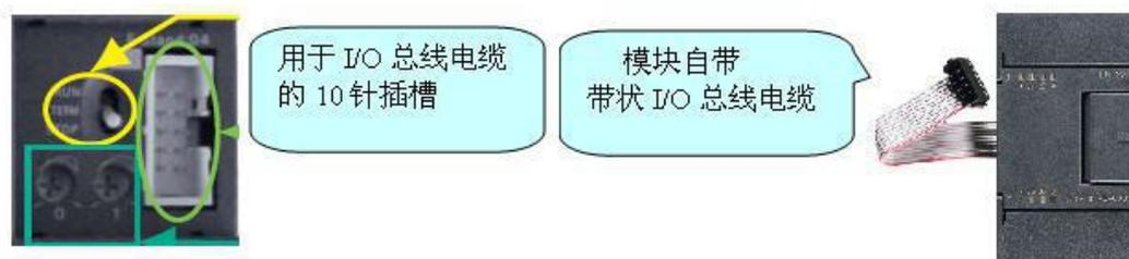
如果 S7-200 数字量模块自带的电缆不能满足模块之间的安装宽度需求，可选用 0.8 米 I/O 扩展电缆。安装示意图如下：
